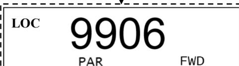
L'intensité moteur se modifie en 9906. Sélectionner le paramètre à modifier (9906) à l'aide des boutons
