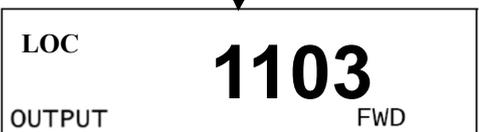
Le paramètre se modifie en 1103. Sélectionner le paramètre à modifier (1103) à l'aide des boutons
