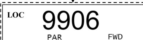
L'intensité moteur se modifie en 9906. Sélectionner le paramètre à modifier (9906) à l'aide des boutons
