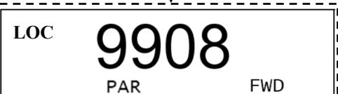
La vitesse moteur se modifie en 9908. Sélectionner le paramètre à modifier (9908) à l'aide des boutons
