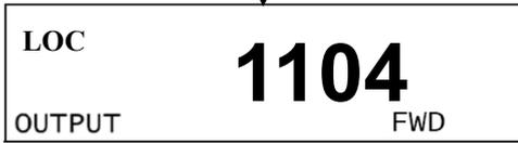
La fréquence de fonctionnement minimum se modifie en 1104. Sélectionner le paramètre à modifier (1104) à l'aide des boutons
