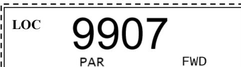
La fréquence moteur se modifie en 9907. Sélectionner le paramètre à modifier (9907) à l'aide des boutons
