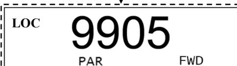
La tension moteur se modifie en 9905. Sélectionner le paramètre à modifier (9905) à l'aide des boutons
