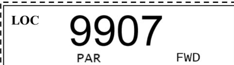
La fréquence moteur se modifie en 9907. Sélectionner le paramètre à modifier (9907) à l'aide des boutons
