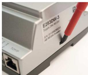
Appuyer sur les clips de chaque côté du boîtier avec un petit tournevis pour désolidariser le couvercle du socle. Maintenez le socle et retirer le couvercle.
